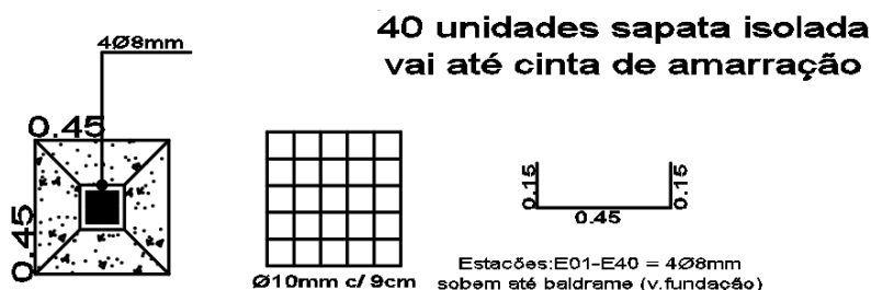
Imagem 01: Detalhe das armaduras do bloco
